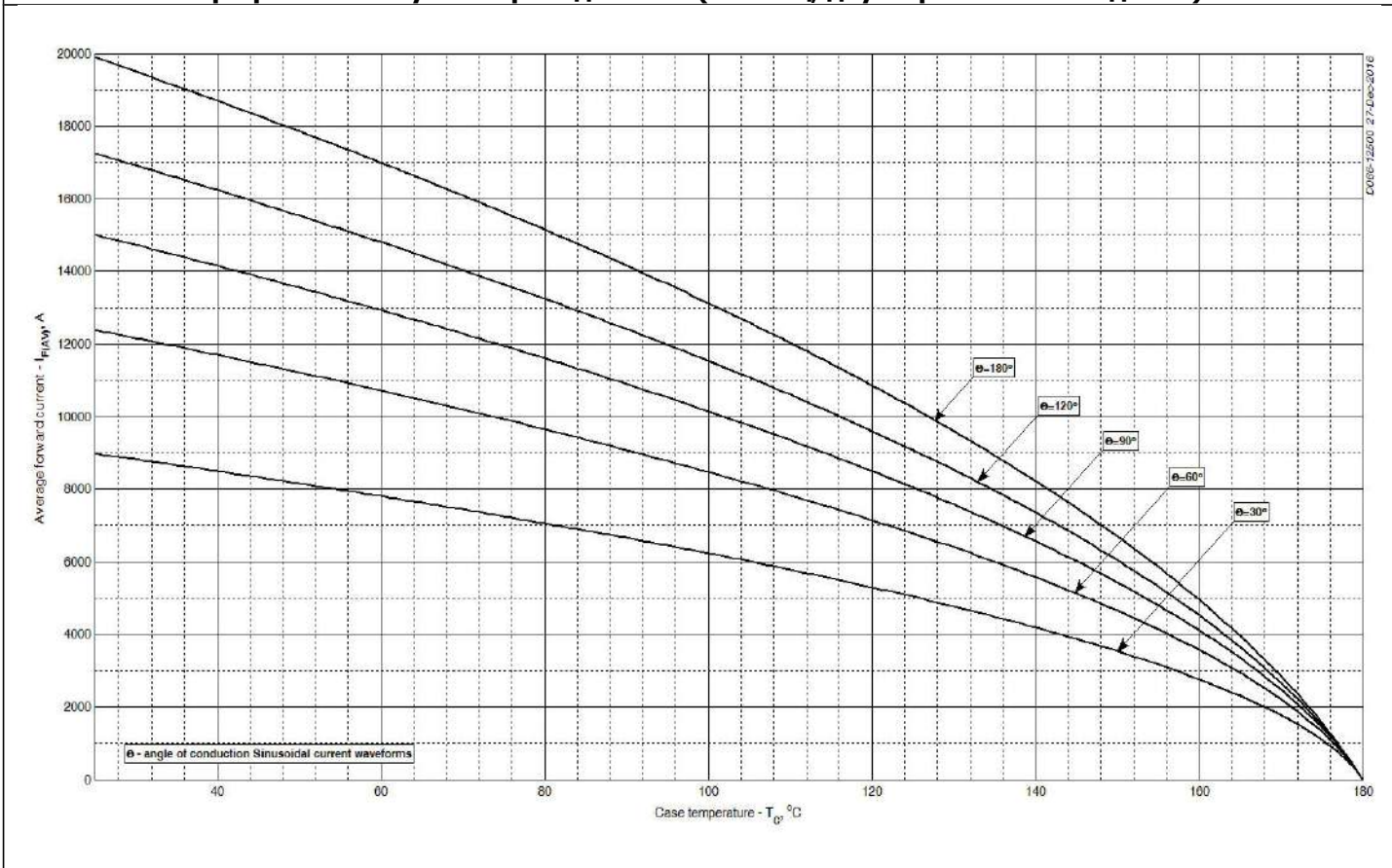
Рис. 8 – Зависимость среднего прямого тока I_{FAV} от температуры корпуса T_c для синусоидальной формы тока при различных углах проводимости ( f=50 Гц, Двустороннее охлаждение)
