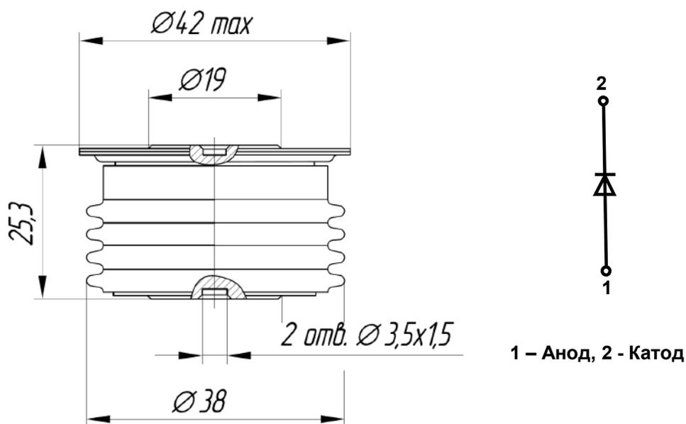
Рис. 1. Габаритные и установочные размеры
