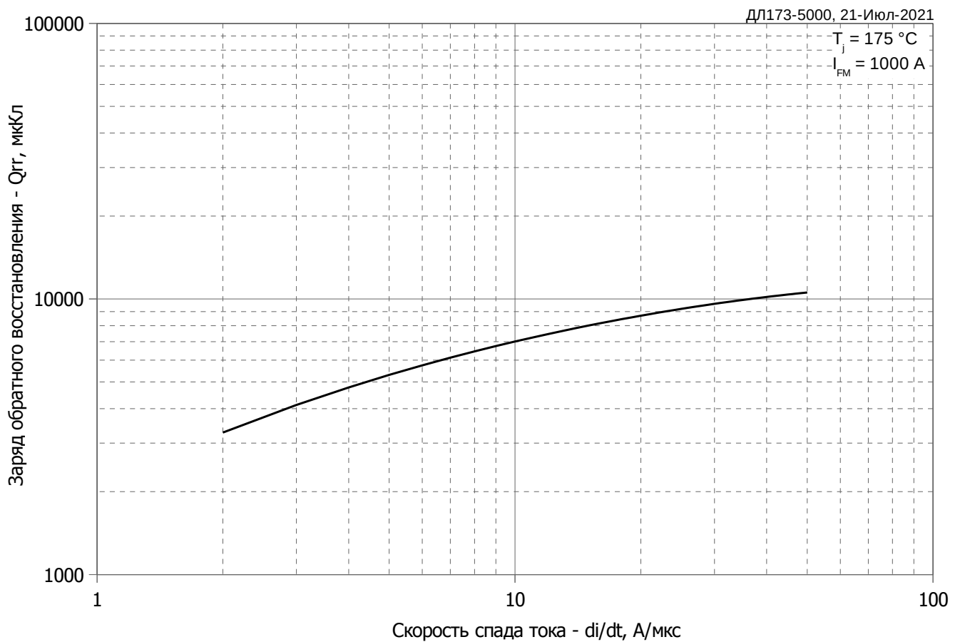
Рис. 4 – Зависимость максимального заряда обратного восстановления Q_{rr} от скорости спада прямого тока di_R/dt (по ГОСТ 24461, хорда 25%)
