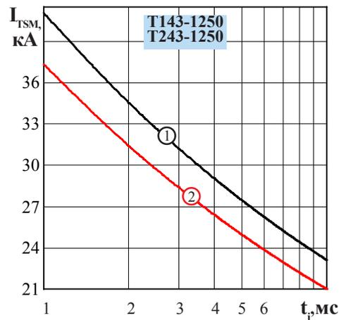
**Рисунок 4** - Зависимость допустимой амплитуды ударного тока в открытом состоянии  $I_{TSM}$  от длительности импульса тока  $t_i$  при исходной температуре структуры  $T_j = 25\text{ }^\circ\text{C}$  (1) и максимальной температуре  $T_{jm}$  (2)
