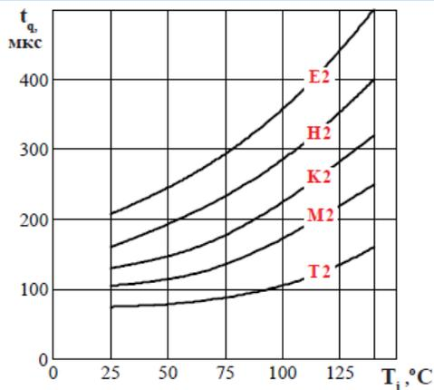
**Рисунок 11** - Зависимость времени выключения  $t_q$  от температуры структуры  $T_j$  при  $I_1 = I_{TAVM}$ ;  $U_D = 0,67 U_{DRM}$ ;  $U_R = 100\text{ В}$ ;  $(di/dt)_f = 5\text{ А/мкс}$ ;  $dU_D/dt = 50\text{ В/мкс}$
