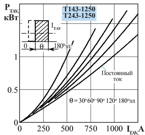
**Рисунок 7** - Зависимость средней рассеиваемой мощности в открытом состоянии  $P_{TAV}$  от среднего тока в открытом состоянии  $I_{TAV}$  прямоугольной формы частотой  $f = 50$  Гц и постоянного тока
