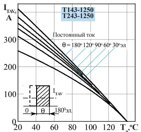
**Рисунок 9** - Зависимость допустимого среднего тока в открытом состоянии  $I_{TAV}$  от температуры окружающей среды  $T_a$  при естественном охлаждении на охладителе ОР243-150 при различных углах проводимости для токов прямоугольной формы частотой  $f = 50$  Гц и постоянного тока
