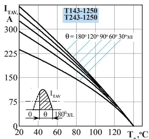
**Рисунок 8** - Зависимость допустимого среднего тока в открытом состоянии  $I_{TAV}$  от температуры окружающей среды  $T_a$  при естественном охлаждении на охладителе ОР243-150 при различных углах проводимости для токов синусоидальной формы частотой  $f = 50$  Гц
