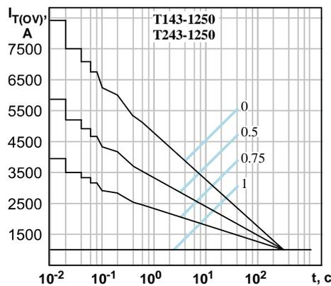
**Рисунок 13:** Зависимость допустимой амплитуды тока перегрузки в открытом состоянии  $I_{T(OV)}$  синусоидальной формы частотой 50 Гц от длительности перегрузки  $t$  при температуре окружающей среды  $40^\circ\text{C}$  и при различных значениях  $k$ , равных отношению предшествующего перегрузке тока  $I_T$  к допустимому среднему току в открытом состоянии  $I_{T(AV)}$  на охладителе OP243-150.
