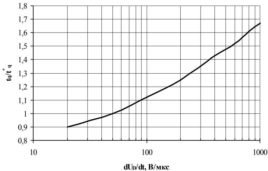
Рис. 30 – Зависимость времени выключения t_q от скорости нарастания напряжения du_D/dt
