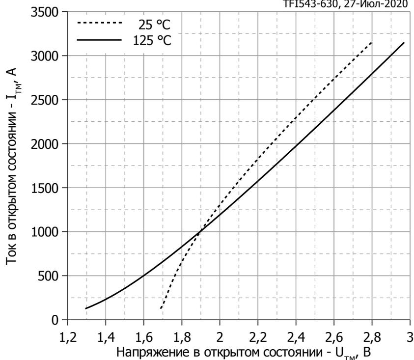
Аналитическая функция предельной вольт — амперной характеристики:
