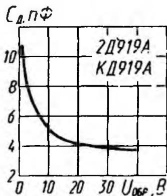
Зависимость общей емкости диода от напряжения
