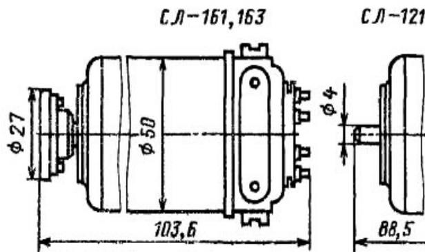
**Габаритные и установочные размеры, мм, и масса двигателей СЛ без стабилизации частоты вращения**
