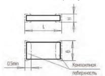
Номинальная емкость: МΠ0 10 пФ – 0,1 мкФ H30 1000 пФ – 2,2 мкФ 1,0-15 мкФ Номинальное напряжение: МΠ0 100; 250; 500 B H30 50; 100; 250; 500 B H90 16: 50 B Интервал рабочих температур: -60/+125 °C МП0, Н30 H90 -60/+85 °C
