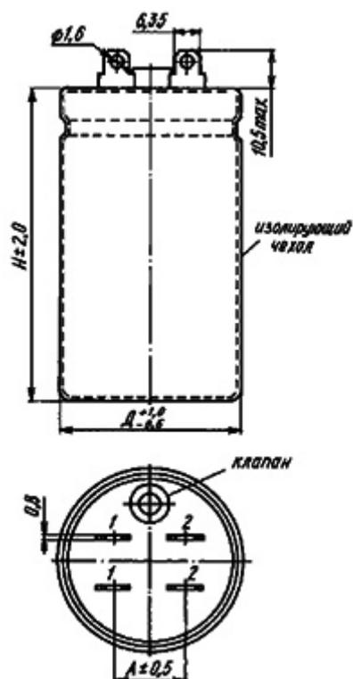
Габаритные размеры и рисунок конденсаторов К50-19
