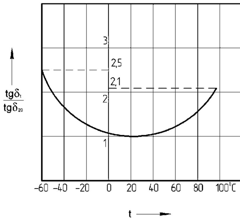
$\text{tg}\delta t$  – тангенс угла потерь при температуре  $t^{\circ}\text{C}$
