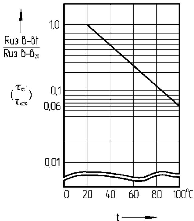
$R_{из\ в-вt}$  – сопротивление изоляции между выводами при температуре  $t^{\circ}\text{C}$ ;
