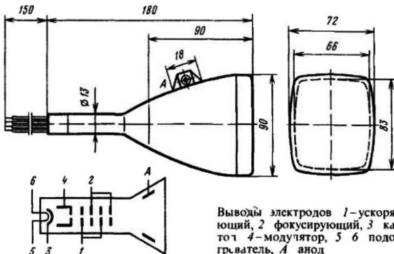
Выводы электродов 1 - ускоряющий, 2 - фокусирующий, 3 - катод, 4 - модулятор, 5, 6 - подогреватель, А - анод
