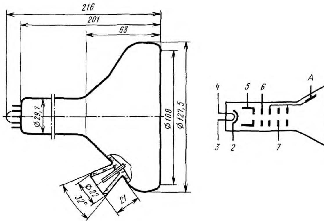
Выводы электродов: 1 - отсутствует; 2 - катод; 3, 4 - подогреватель; 5 - модулятор; 6 - ускоряющий; 7 - фокусирующий; А - анод.
