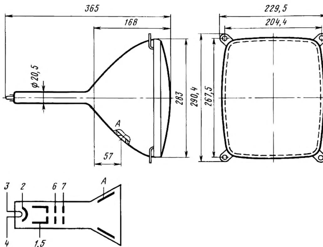
Выводы электродов: 1, 5 - модулятор, 2 - катод, 3, 4 - подогреватель, 6 - ускоряющий, 7 - фокусирующий, А - анод.
