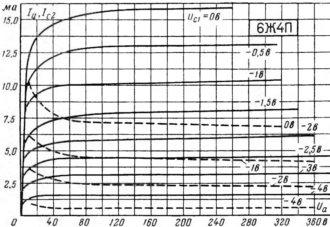
Анодные (сплошные) и сеточно-анодные по сетке второй (штриховые) характеристики лампы 6Ж4П при напряжении сетки второй 150 в и напряжении сетки третьей 0 в.
