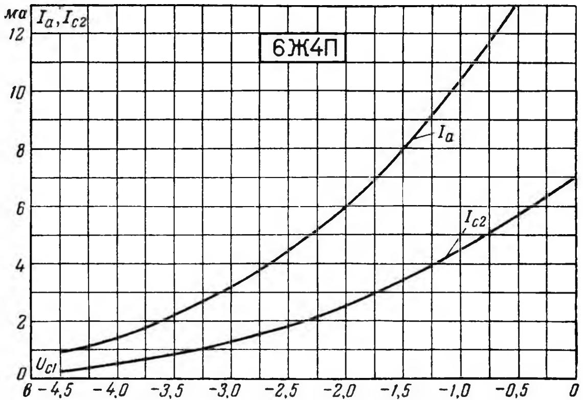
Анодно-сеточная ( $I_a$ ) и сеточная по сетке второй ( $I_{c2}$ ) характеристики лампы 6Ж4П при напряжении анода 250 в, напряжении сетки второй 150 в и напряжении сетки третьей 0 в.
