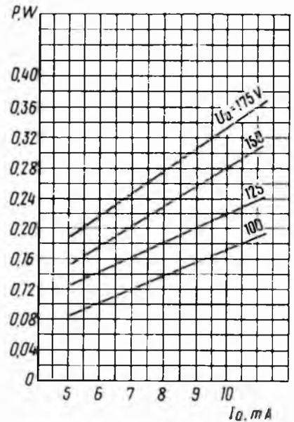
Усредненные характеристики зависимости колебательной мощности от тока анода:
