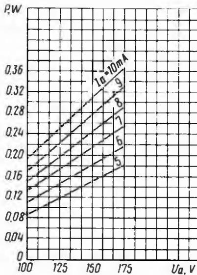
Усредненные характеристики зависимости колебательной мощности от напряжения анода:
