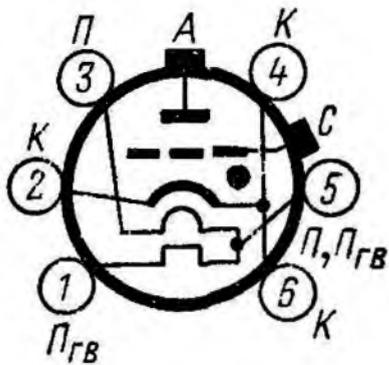
Тиратрон для работы в импульсных схемах. Наполнение — водородное. Охлаждение анода и сетки — жидкостное, 1—1,3 л/мин (в режиме дежурного подогрева расход жидкости может быть снижен до 0,4 л/мин). Оформление — металlostеклянное. Масса 6 кг.
