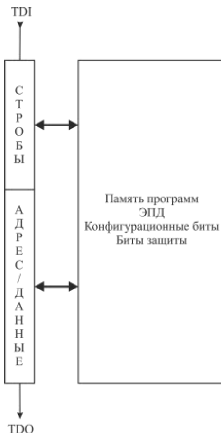
Рисунок 3.149 – Регистр команд программирования
