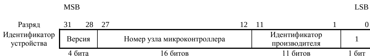
Рисунок 3.123 – Формат регистра идентификации устройства
