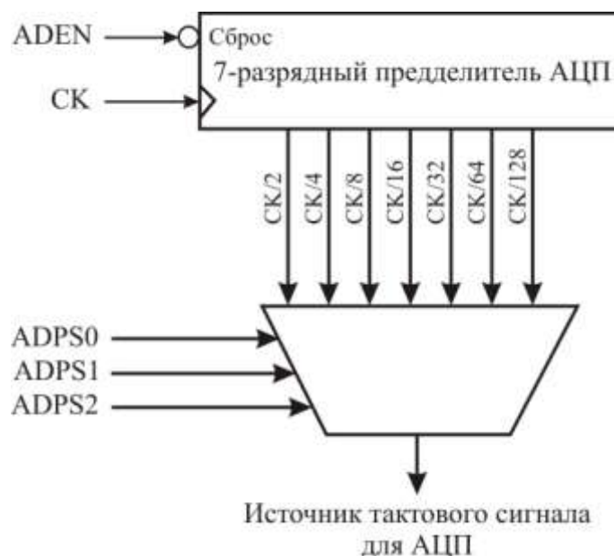
Рисунок 3.110 – Пределитель АЦП
