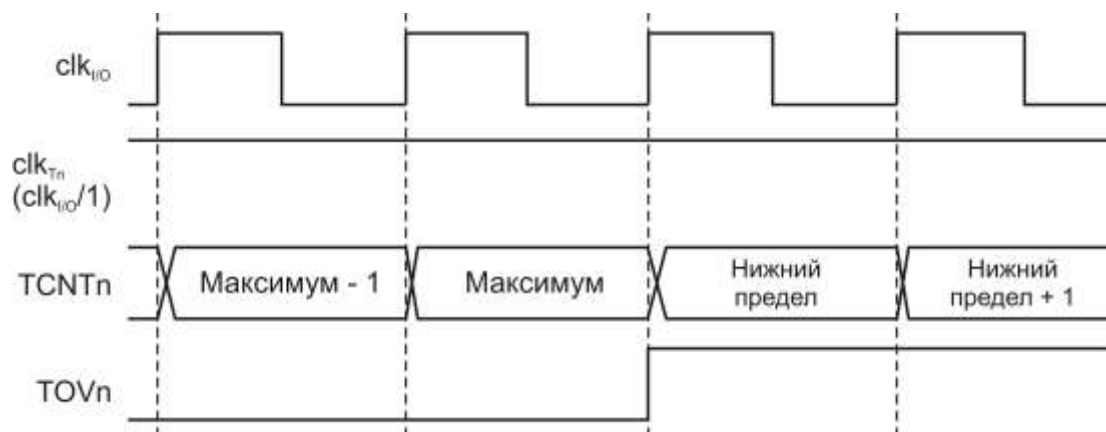
Рисунок 3.69 – Временная диаграмма таймера/счетчика без делителя
