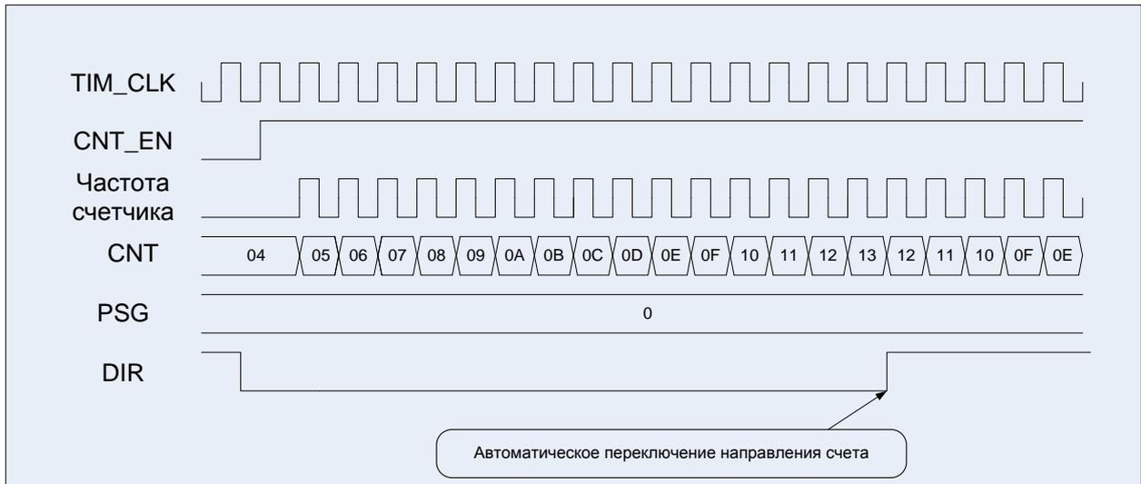
**Рисунок 89 – Диаграммы работы таймера, счет вверх/вниз, сначала вверх**
