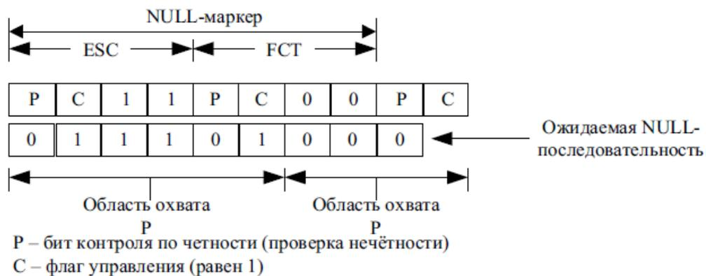
**Рисунок 85 – Декодирование NULL-последовательности**
