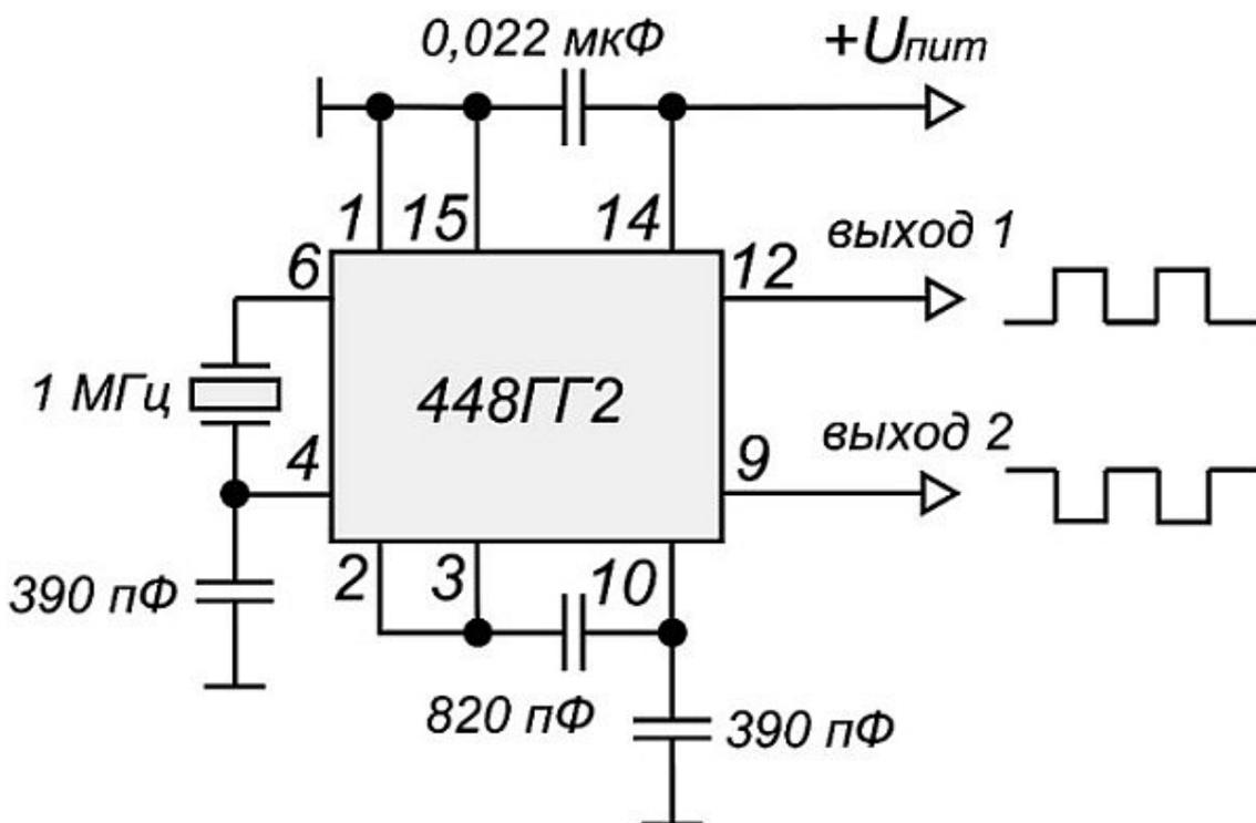
На рисунке показана схема включения микросхемы как кварцевого генератора с парафазными выходами, на частоту 1 МГц.
