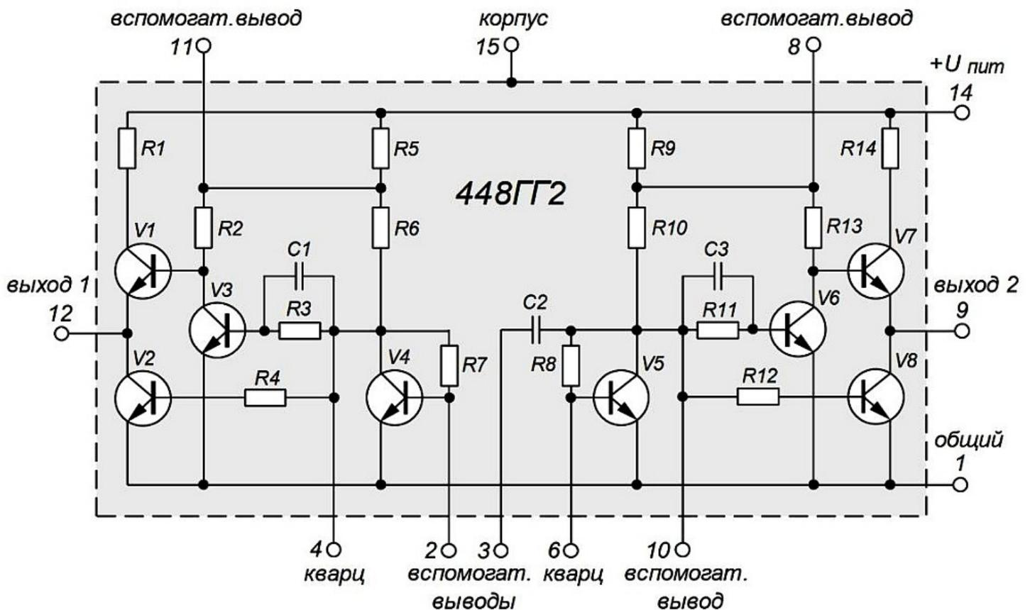
Микросхема содержит два идентичных усилителя импульсов, выполненные на транзисторах V1...V4 и V5...V8 соответственно.
