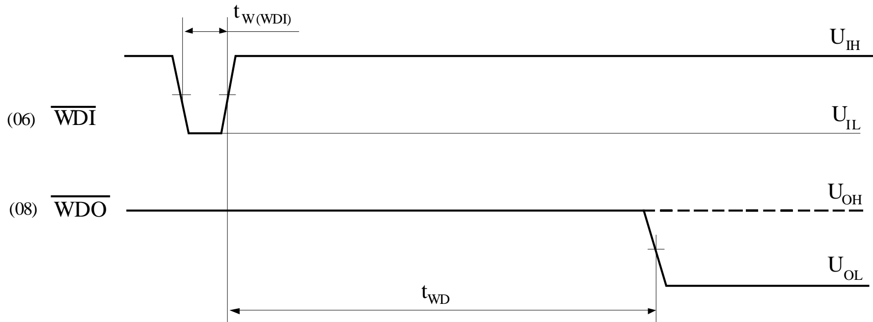
Рисунок 7 – Временная диаграмма входных и выходных импульсов при контроле t_{wD}
