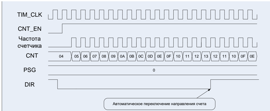
Рисунок 60 – Диаграммы работы таймера, счет вверх/вниз, сначала вверх Счет вверх/вниз: CNT_MODE = 01, DIR = 1
