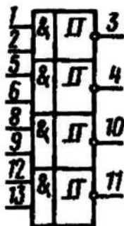
Условное графическое обозначение К561ТЛ1, КР561ТЛ1
