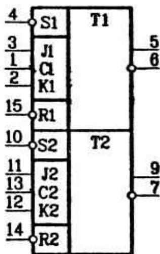
Условное графическое обозначение КР1533ТВ9, КФ1533ТВ9, ЭКФ1533ТВ9
