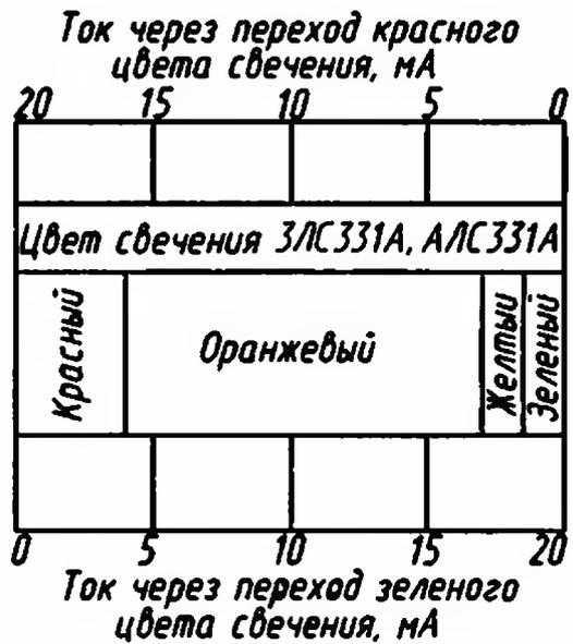
Зависимость цвета свечения от постоянного прямого тока при одновременном включении *p-n* переходов
