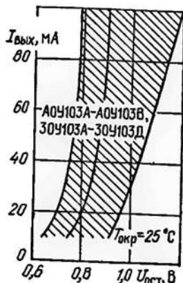
Выходная вольт-амперная характеристика в открытом состоянии оптотары (показаны зона разброса и усредненная кривая)
