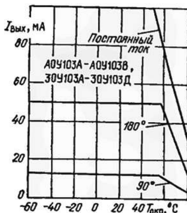
Зависимость выходного тока от температуры окружающей среды при различных значениях угла горения
