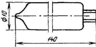
Индикация производится по высоте светящегося столбика через боковую поверхность баллона
