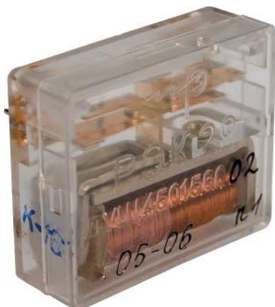
Электромагнитное реле средней мощности постоянного тока, с двумя переключающими контактами, предназначено для коммутации электрических цепей постоянного и переменного тока с частотой до 60 Гц.
