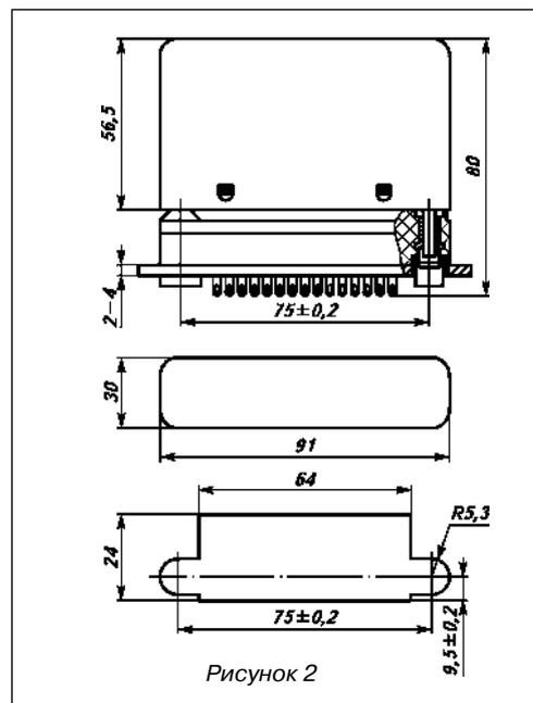
Рис. 2. Габаритные, установочные размеры и масса реле серии РПГ-9 со штепсельным разъемом
