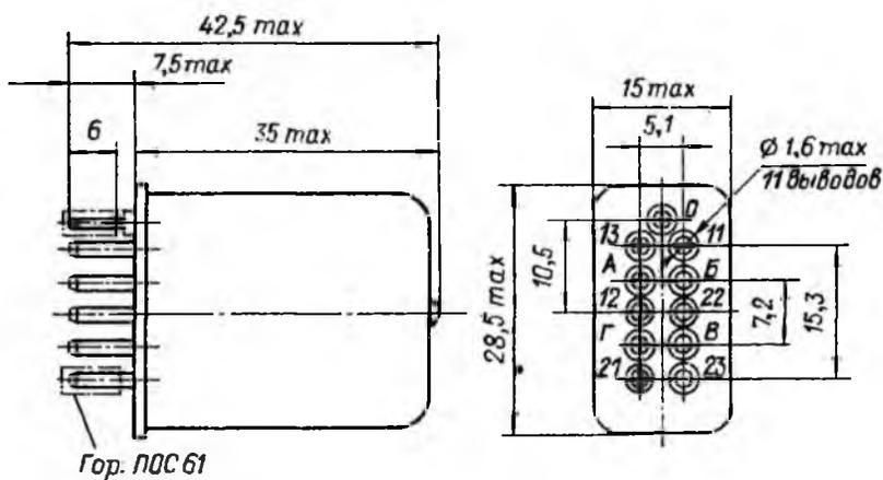
Рис. 2-160. Конструктивные данные реле РПС42А
