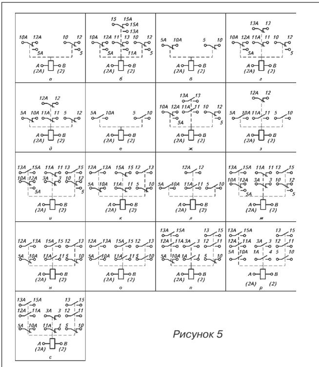
Рис. 5. Электрические принципиальные схемы реле типов РПУ-2-0(5):
