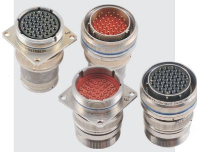
Соединители (вилки и розетки) предназначены для работы в электрических цепях постоянного и переменного (частотой до 3 МГц) токов при напряжении до 700 В (амплитудное значение).
