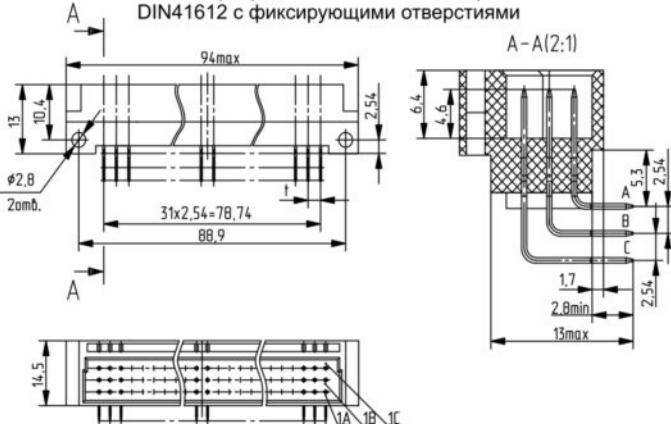
Рисунок 5 Вилки трехрядные аналог вилок серии DIN41612 с фиксирующими отверстиями
