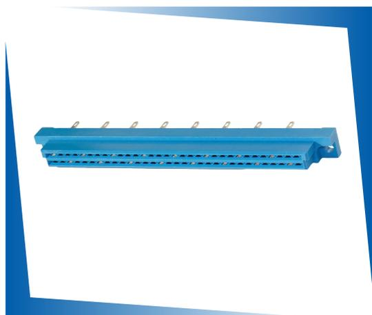
Соединители электрические низкочастотные прямоугольные типов **СНП58** для печатного монтажа и **СНО63** для объемного монтажа, врубного сочленения предназначены для работы в электрических цепях постоянного, переменного и импульсного токов при напряжении до 250В, 400В, 1000В (в зависимости от контактности) и силе тока до 2А.
