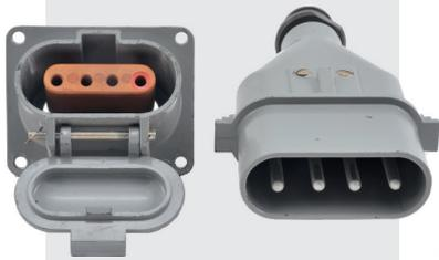
Соединители предназначены для соединения гибких силовых кабелей между собой, а также с передвижными и стационарными источниками и приемниками электрической энергии в цепях постоянного и переменного токов частотой до 50 Гц при напряжении до 400 В (амплитудное значение).
