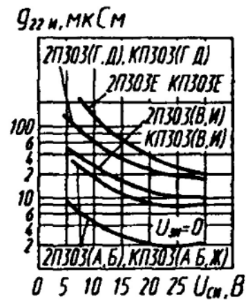
Зависимости активной составляющей выходной проводимости от напряжения сток—исток
