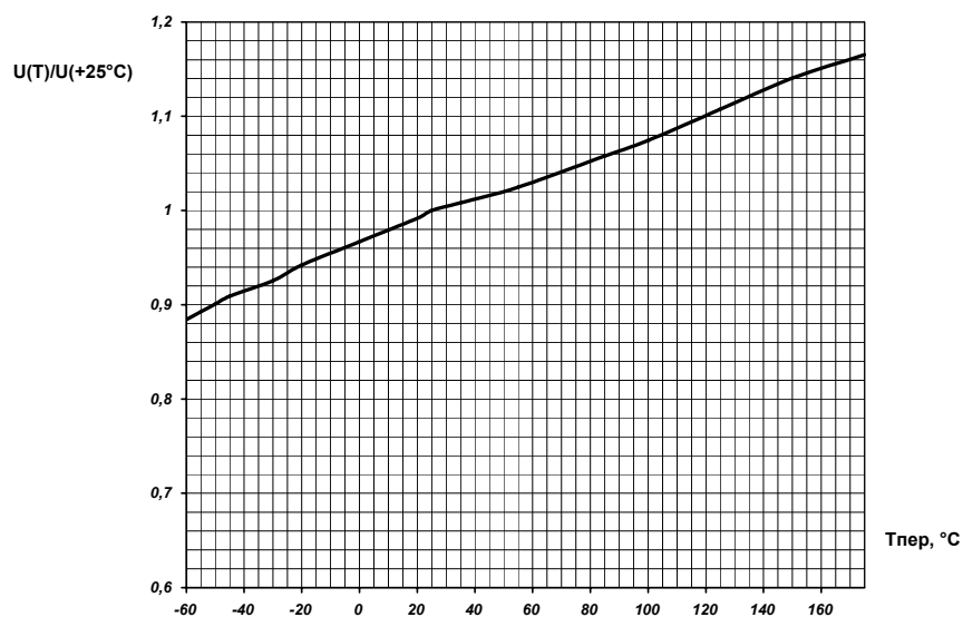
Рисунок 11. Нормализованная зависимость пробивного напряжения сток-исток от температуры перехода при I_c=250\text{мкА} ( U_{си.проб.}(T_{пер})/U_{си.проб.}(T_{пер}=+25^\circ\text{C}) ).
