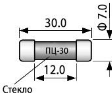
Габаритные и установочные размеры предохранителя ПЦ-30.
