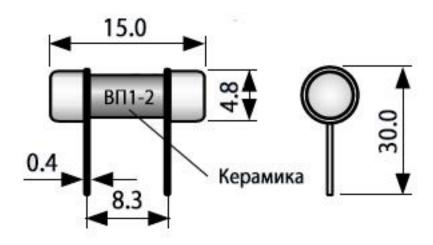
Габаритные и установочные размеры вставки плавкой ВП1-2, ВП1-2В.
