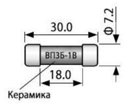
Габаритные и установочные размеры вставки плавкой ВПЗБ-1В.
