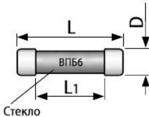
Габаритные и установочные размеры вставки плавкой ВПБ6.
