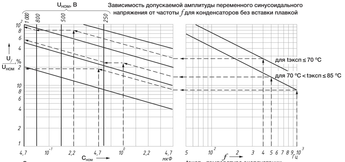
Для конденсаторов со вставкой плавкой амплитуда переменного синусоидального напряжения - составляет 77 % от значений, определяемых по рисунку.
