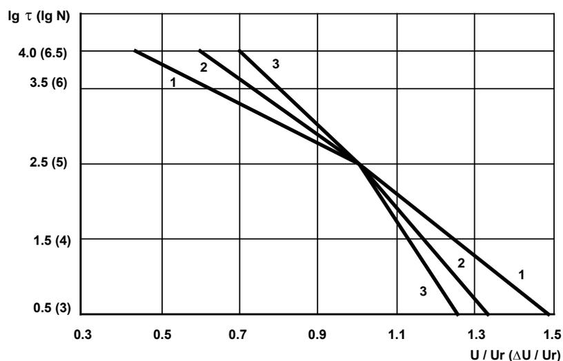
$\tau$  - в часах; N - количество импульсов; U – рабочее – постоянное (пульсирующее) напряжение;  $\Delta U$  - размах импульсного напряжения
