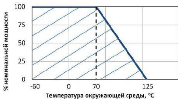
Нагрузочная кривая от температуры окружающей среды
