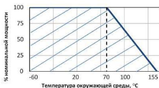
Нагрузочная кривая от температуры окружающей среды
