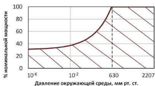
Нагрузочная кривая от давления окружающей среды
