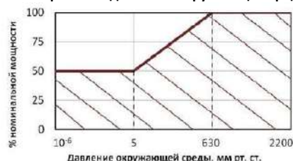
Нагрузочная кривая от давления окружающей среды
