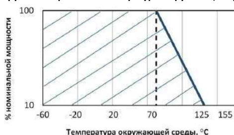
Нагрузочная кривая от температуры окружающей среды
