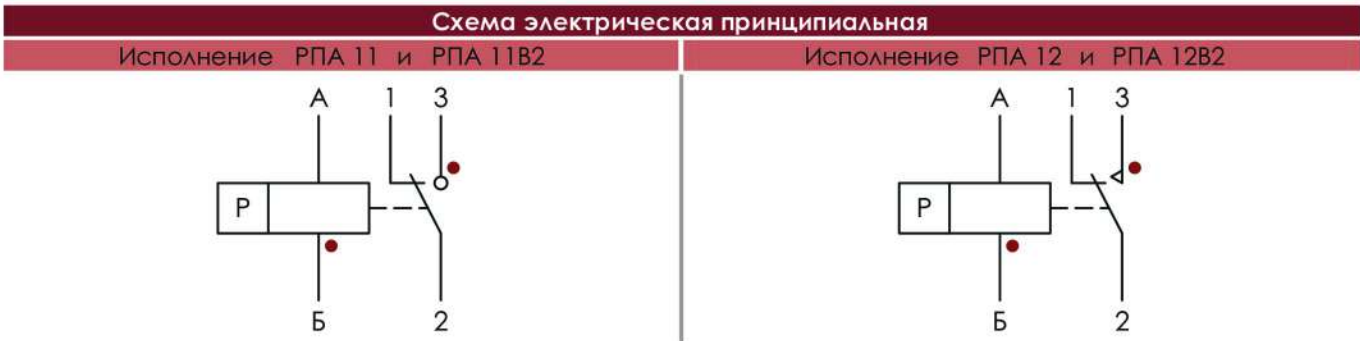
Габаритные, установочные и присоединительные размеры. Расположение выводов контактов и обмоток Исполнение РПА 11, РПА 11В2, РПА 12, РПА 12В2
