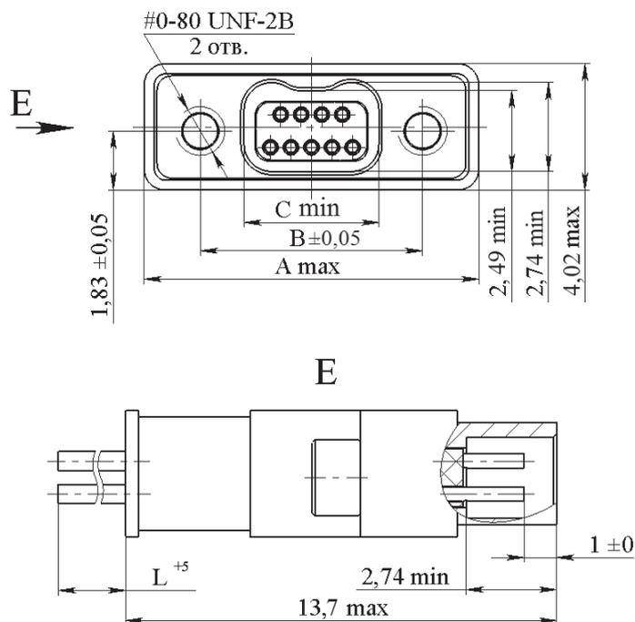
Рисунок 14 – Соединитель СП450-11...2...Г2...
