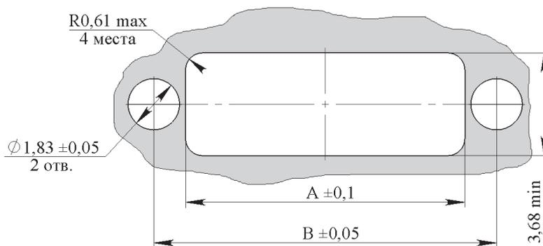
Рисунок 19.3 – Разметка отверстий СП450-04...2...Г1...
