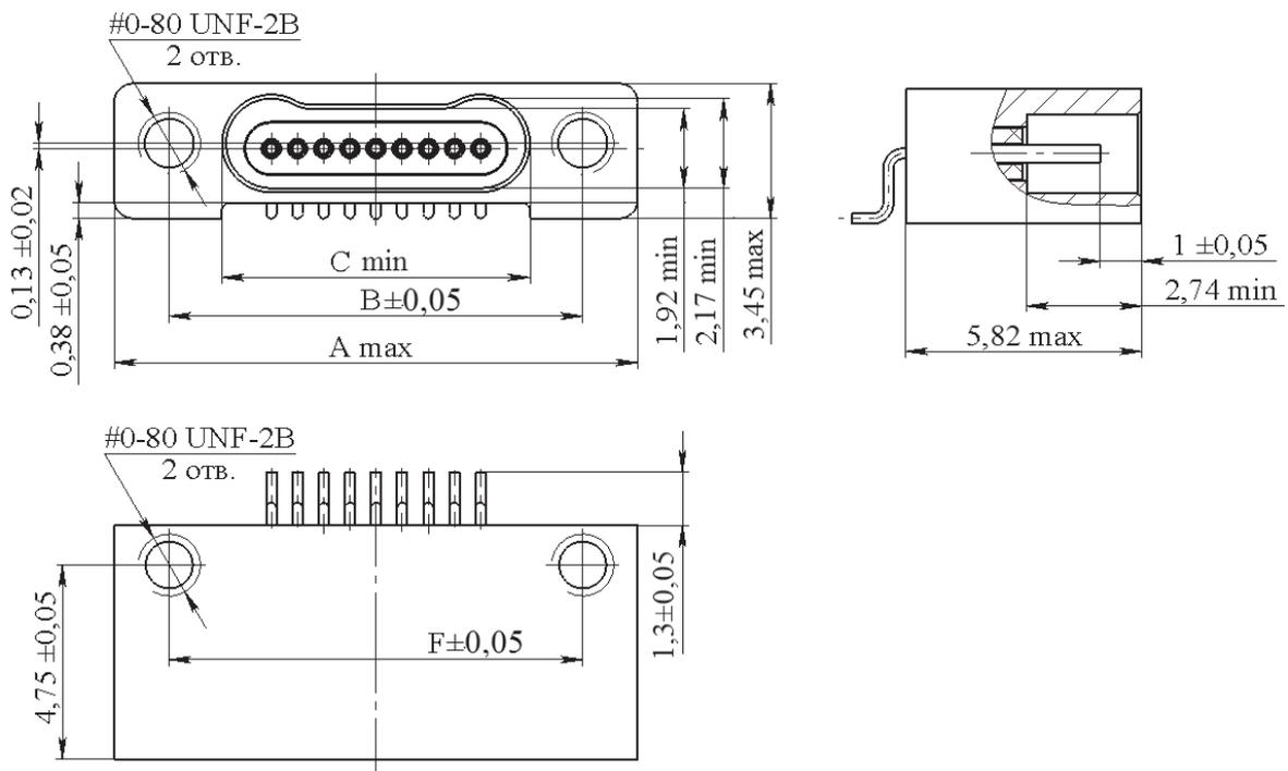
Рисунок 6.1 – Соединитель СП450-02...1...Г1...
