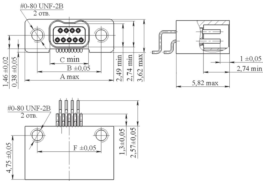
Рисунок 16.1 – Соединитель СП450-02...2...Г1...
