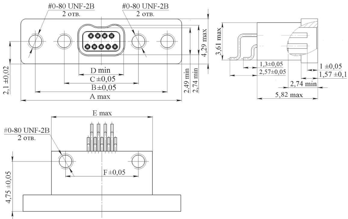
Рисунок 19.1 – Соединитель СП450-04...2...Г1...
