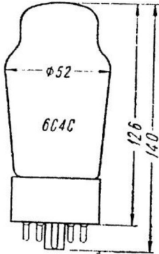
Рис. 467. Лампа 6С4С: а — основные размеры; б — схематическое изображение; 1, 4, 6 и 8 — свободные; 2 и 7 — подогреватель (накал); 3 — анод; 5 — сетка.
