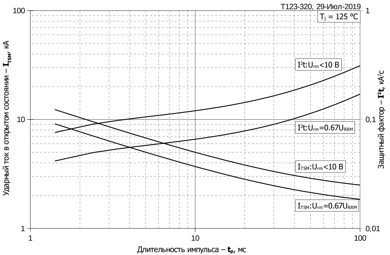
Рис. 11 – Зависимость максимальной амплитуды ударного тока в открытом состоянии I_{TSM} и защитного фактора I^2t от длительности импульса t_p
